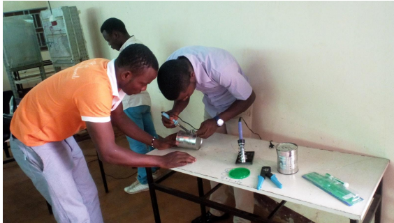
Antenne aus einer Konservenbüchse, Löteisen und Lötzinn
